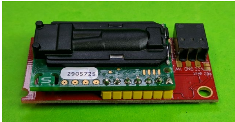
Bild 1: CO 2 -Sensor mit 1-Wire Modul
