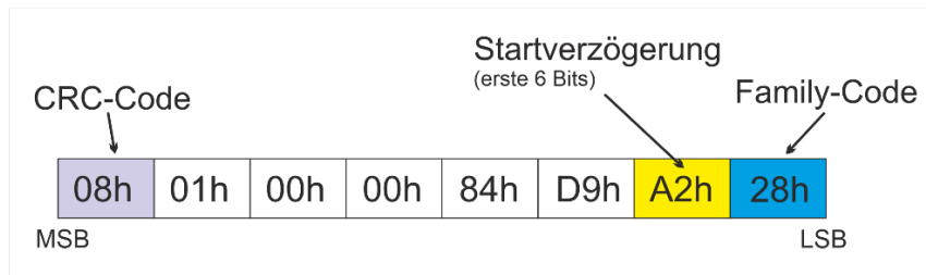
Bild 7: Grundlage des Verzögerten Mess-Startes um Stromspitzen zu vermeiden.
